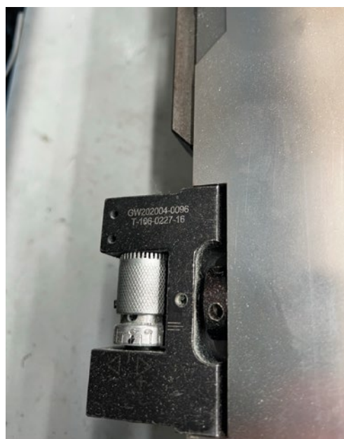
Abb. 3: Mikrometer an Stanzplatte ist schlecht ablesbar.
